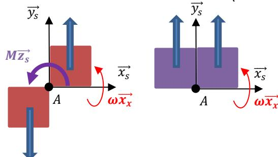
**Symétries et forme de la matrice d'inertie –  $O$  sur l'élément de symétrie**
