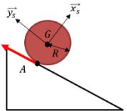
$(A, \vec{z}_S)$  soumis à la gravité et à la force tangentielle  $T$  au contact en  $A$ . On a :  $C\ddot{\theta} = -RT$
